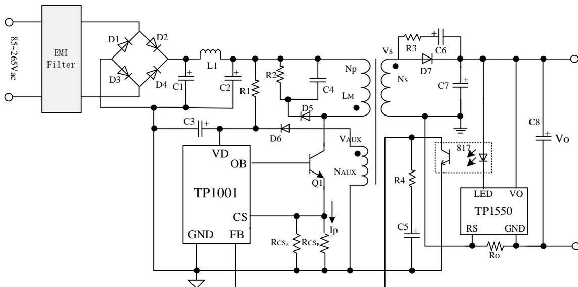
图 8 5V/2A 电源适配器原理图
