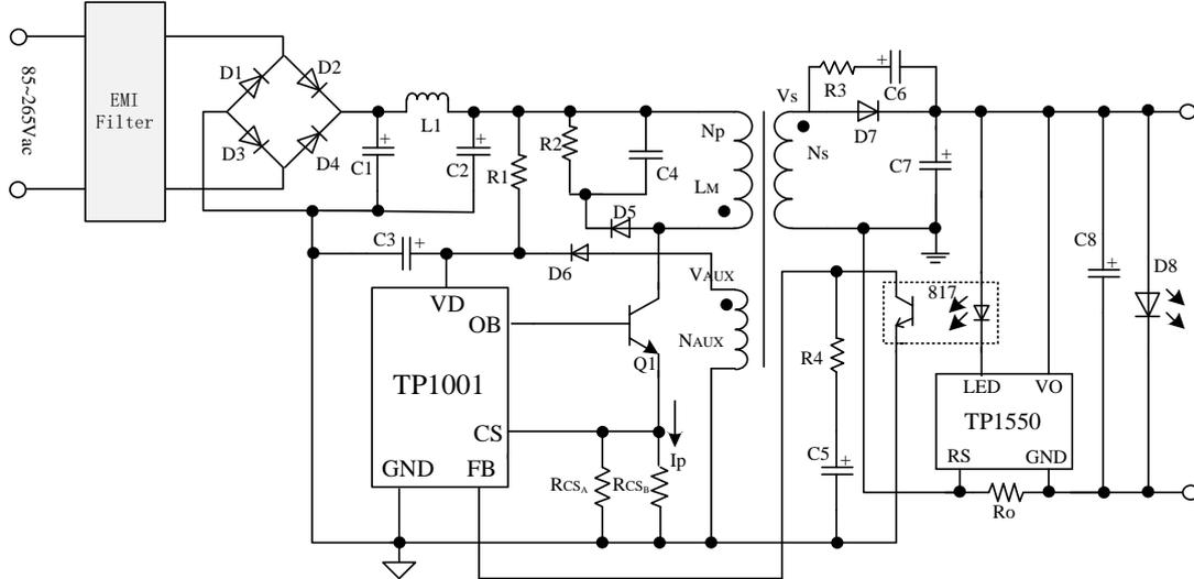
图 10 恒流驱动单颗 LED 原理图
