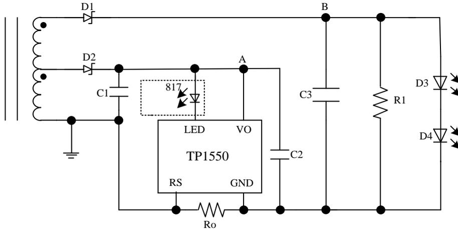
图 11 恒流驱动两颗 LED 原理图
