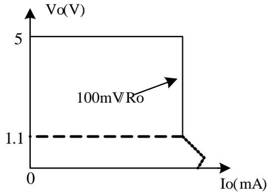
图 7 输出电压电流特性曲线
